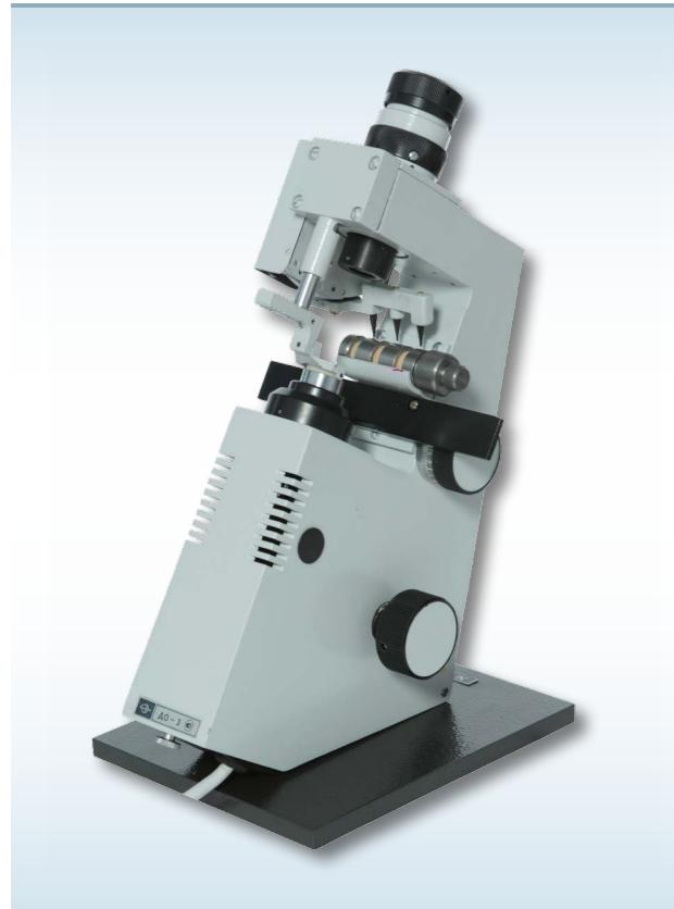
Предназначен для измерения задней вершинной рефракции и призматического действия очковых линз диаметром от 34 до 75 мм, для нанесения положения оптического центра, положения главных сечений у астигматических линз и направления главных сечений у призматических очковых линз.
