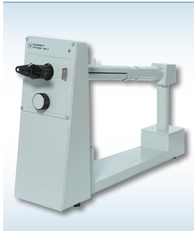
Прибор предназначен для измерения угла вращения плоскости поляризации оптически активными прозрачными однородными растворами и жидкостями. Поляриметр визуального типа удобен в эксплуатации, обладает высокой надежностью и точностью измерений, соответствует современным эстетическим и эргономическим требованиям.
