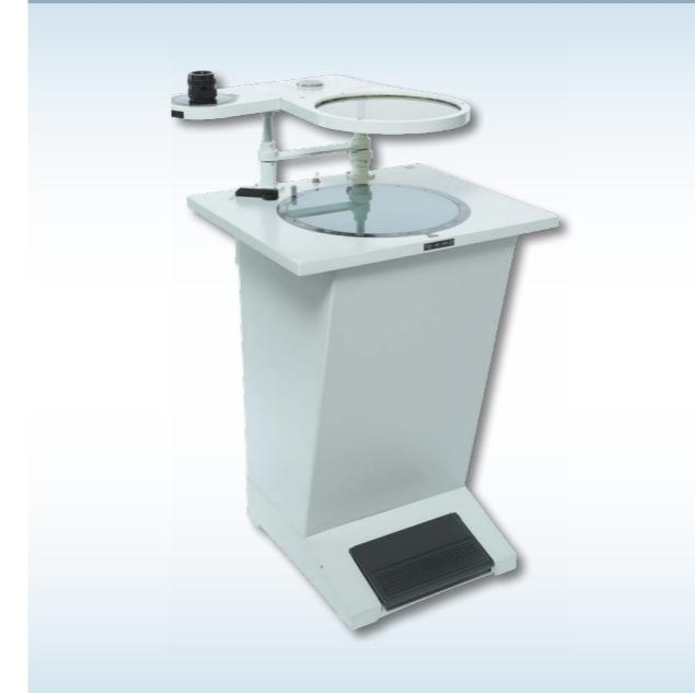
Прибор предназначен для определения двойного лучепреломления в плоских заготовках и изделиях из прозрачных и слабоокрашенных материалов; используется для количественной оценки величины двойного лучепреломления методом Сенармона, для оценки распределения двойного лучепреломления в объекте по интерференционной окраске, для исследований распределения двойного лучепреломления в объекте в свете, поляризованном по кругу.
