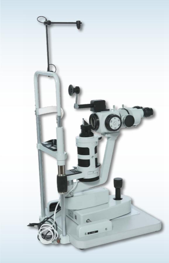
Щелевая лампа предназначена для биомикроскопического исследования переднего отдела глаза, а так же с помощью дополнительной отрицательной линзы Хруби и заднего отдела глаза. Прибор оснащен бинокулярным стереомикроскопом с устройством для дискретной смены увеличений. Обеспечена возможность работы в очках.
